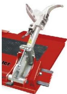
Sistema **ST** : Subida y bajada y cambio plato/ uña manual sistema rápido
